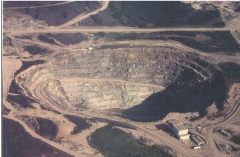
การทำเหมืองแร่ทองแดงโดยวิธีเหมืองเปิดขนาดใหญ่
