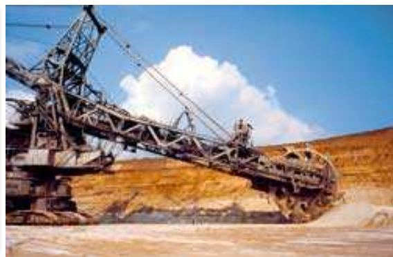
การขุดหน้าดินด้วยรถขุด back hoe กับรถบรรทุกและโดยการใช้ Bucket Wheel Excavator
