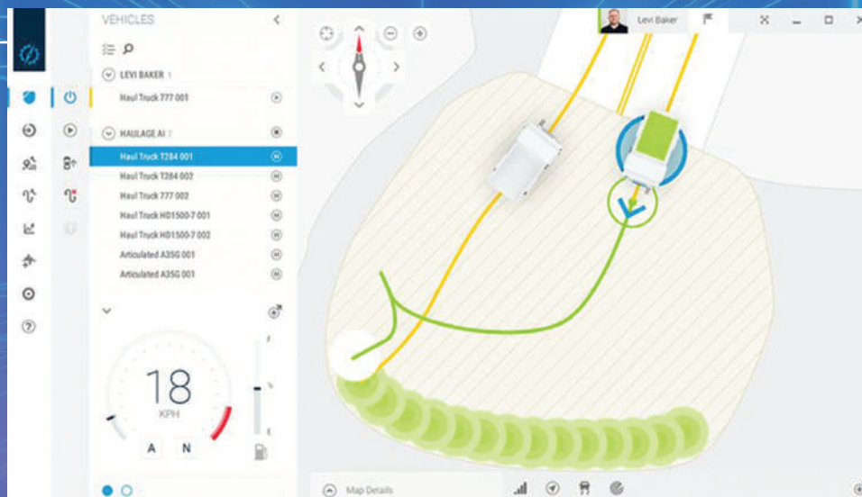
รูปที่ 2 แสดงการสั่งการและควบคุมรถยนต์งานเหมืองของ Mobius™ ภาพจาก https://asirobots.com/platforms/mobius/
