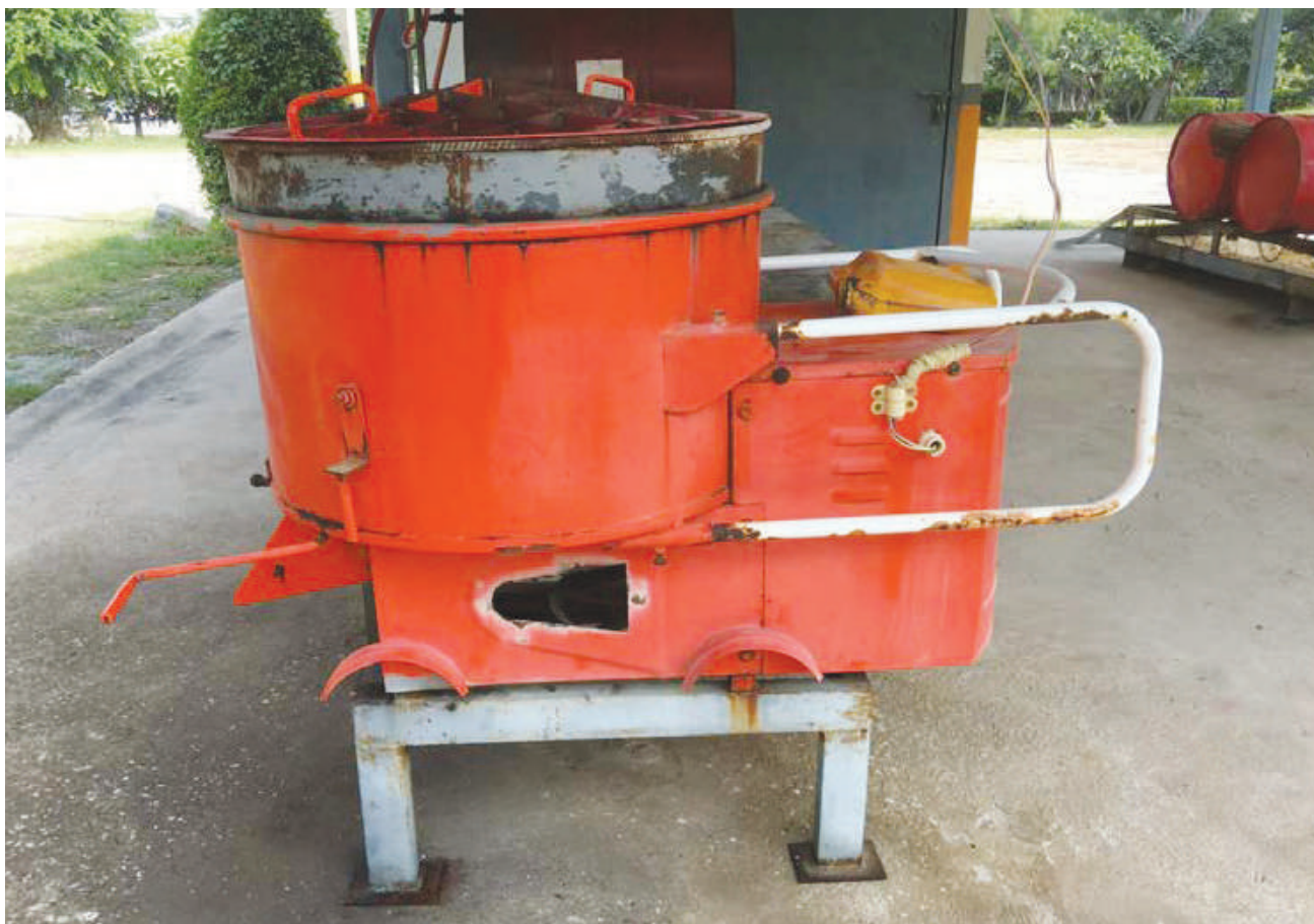
ลักษณะของเครื่องมือหรือเครื่องจักรที่ใช้ในการผสมปุ๋ยแอมโมเนียมไนเตรดกับน้ำมันดีเซล ในอัตราส่วน 94 : 6 ให้เป็นวัตถุระเบิด ANFO
