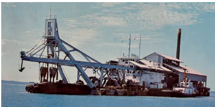
เรือขุดแร่ “เทมโก้ 2” หรือ “นารายณ์” ของบริษัท บิลลิตันฯ ซึ่งรับจ้างขุดแร่ให้กับองค์การเหมืองแร่ในทะเล
