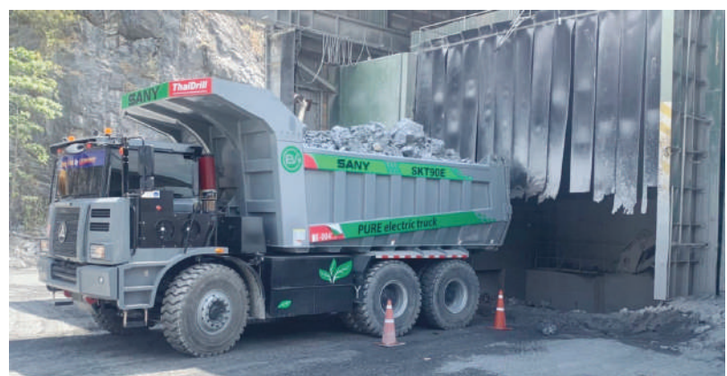
นำรถบรรทุกขนาด 60 ตัน ชนิดไฟฟ้า (EV Mining Truck) มาใช้ในการขนถ่ายหินปูนด้วยพลังงานไฟฟ้า
