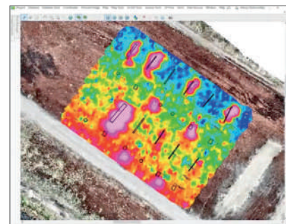
รูปที่ 6 ภาพจากมุมมองด้านบน (Top View) แสดงขอบของวัตถุที่ฝังไว้ใต้ดิน (สีดำ) และขอบเขตของสีที่แสดงค่าแรงดันไฟฟ้า ซึ่งมีตำแหน่งตรงกันในวัตถุบางชิ้น และมีความคลาดเคลื่อนบ้างในวัตถุบางชิ้น เนื่องจากกระแสลมทำให้ขดลวดแกว่งไปมา
