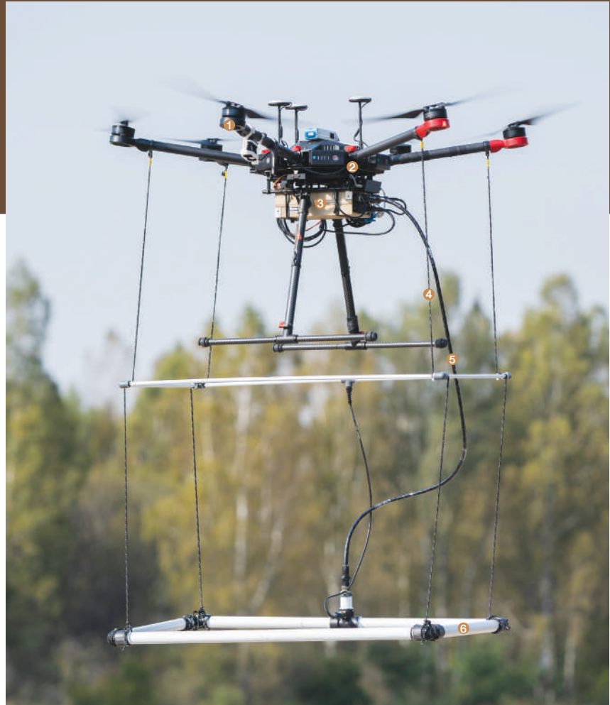
รูปที่ 1 แสดงโดรนตรวจจับวัตถุที่เป็นโลหะใต้ผิวดินของบริษัท SPH Engineering ภาพจาก https://integrated.ugcs.com/files/metal-detector/drone-integrated-metal-detector.pdf
