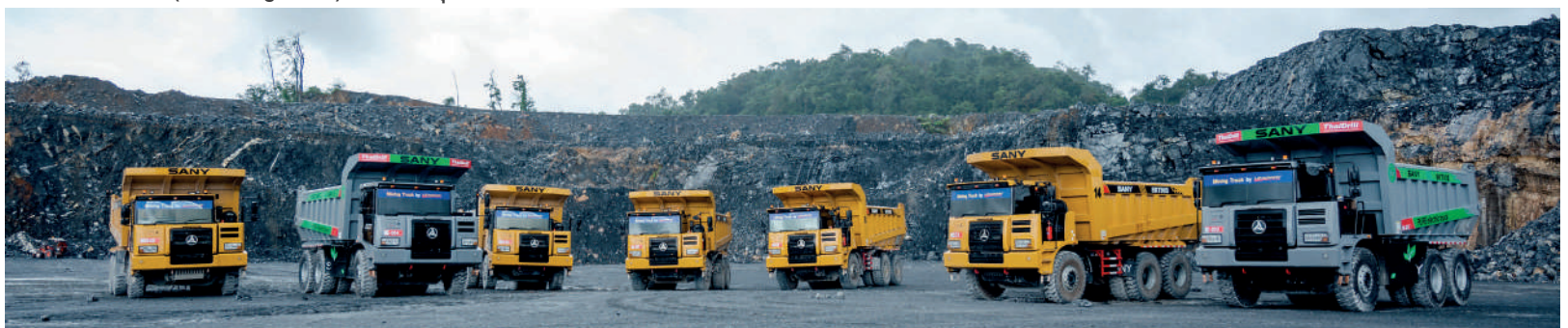
รถบรรทุกเหมืองแร่ชนิดไฟฟ้า (EV Mining Truck) ขนาดบรรทุก 60 ตัน
