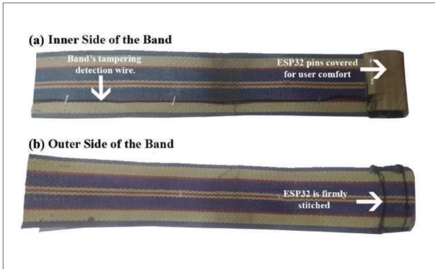
รูปที่ 7 แสดงลักษณะด้านในและด้านนอกของสายรัดข้อมืออัจฉริยะ ภาพจาก Singh et al. (2020)
