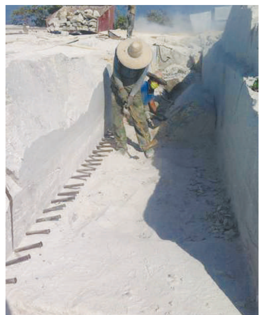
การใช้ลิ้มตอกหินแยกหินออกจากใช้เครื่องตัดแบบเลื่อยวงเดือน
