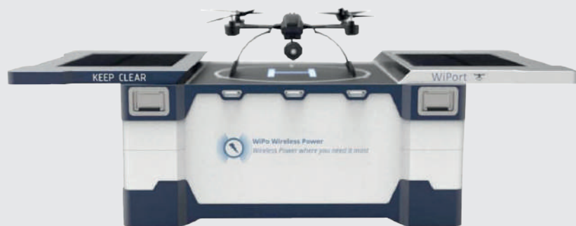
รูปที่ 4 แสดง Drone in a Box โดรนในกล่องที่สามารถบินอัตโนมัติโดยไม่ต้องใช้เจ้าหน้าที่บังคับ ภาพจาก https://flytnow.com/drones-for-public-safety/
