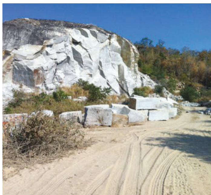
การทำเหมืองหินประดับชนิดหินแกรนิตในอดีต ที่ใช้การระเบิดร่วมกับลิ้มดอกเพื่อแยกหินออก
