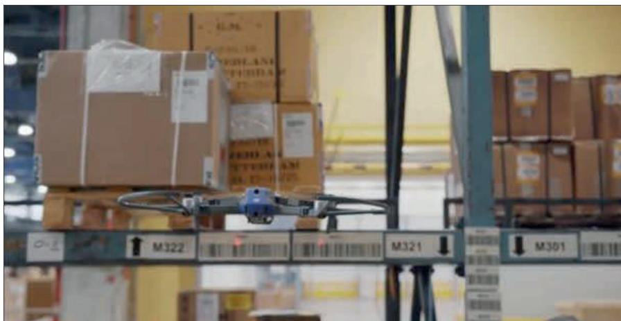
รูปที่ 9 โดรนขณะสแกน Barcode กล่องสินค้า ภาพจาก https://www.youtube.com/watch?v=PETeQDif2OU
