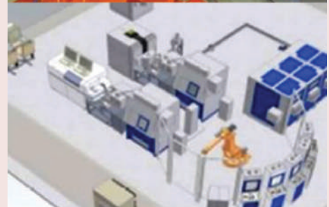
รูปที่ 9 แสดงผังและภาพห้องปฏิบัติการวิเคราะห์เหล็ก อัตโนมัติด้วยหุ่นยนต์ของบริษัท FLSmidth ภาพจาก https://www.flsmidth.com/en-gb/products/steel-laboratory-automation
