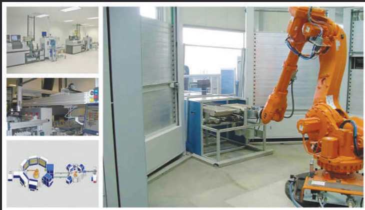
รูปที่ 6 แสดงผังและภาพห้องปฏิบัติการวิเคราะห์โลหะที่ไม่ใช่เหล็กอัตโนมัติ ด้วยหุ่นยนต์ของบริษัท FLSmidth ภาพจาก https://www.flsmidth.com/en-gb/products/phosphate-laboratory-automation
