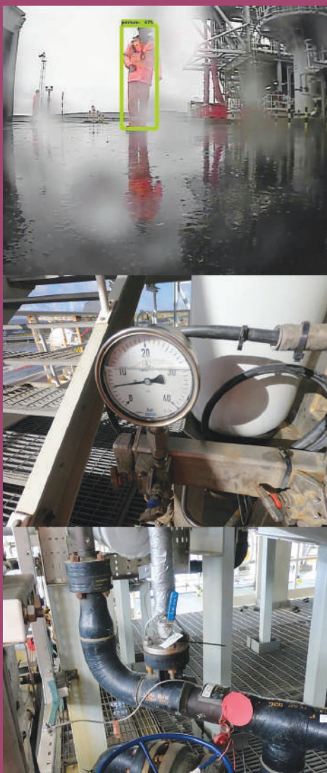
รูปที่ 3 ความสามารถของหุ่นยนต์ Taurob (บน) ตรวจจับสิ่งกีดขวาง (กลาง) อ่านมาตรวัด (ล่าง) ตรวจวัดการสั่นสะเทือน ภาพจาก https://taurob.com/wp-content/uploads/2020/08/Technical-Product-Sheet.pdf
