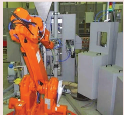
รูปที่ 8 แสดงผังและภาพห้องปฏิบัติการวิเคราะห์โลหะมีค่า อัตโนมัติด้วยหุ่นยนต์ของบริษัท FLSmidth ภาพจาก https://www.flsmidth.com/en-gb/products/precious-metal-laboratory-automation
