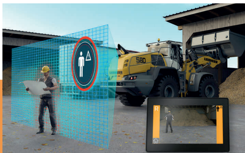
รูปที่ 3 แสดงระบบตรวจจับบุคคลด้านหลังรถดักล้อยางของบริษัท Liebherr ภาพจาก https://www.liebherr.com/shared/media/construction-machinery/earthmoving/brochures/wheel-loaders/assistance-systems-for-the-liebherr-wheel-loaders/liebherr-radlader-ass.-us.pdf
