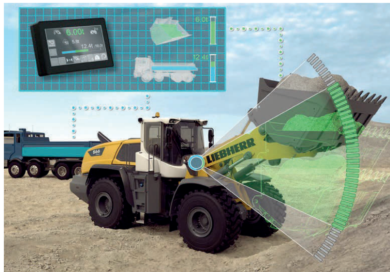
รูปที่ 1 การชั่งน้ำหนักแร่ในบั้งก์และการแจ้งน้ำหนักแร่ในรถบรรทุก ซึ่งแสดงผลผ่านหน้าจอในห้องโดยสารของรถดักล้อยาง ภาพจาก https://www.liebherr.com/shared/media/construction-machinery/earthmoving/brochures/wheel-loaders/assistance-systems-for-the-liebherr-wheel-loaders/liebherr-radlader-ass.-us.pdf
