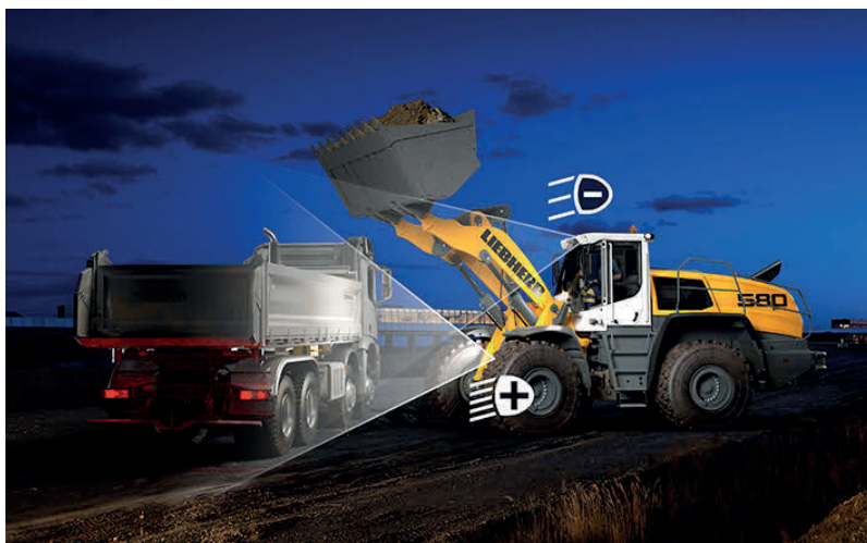
รูปที่ 2 แสดงการปรับแสงสว่างของไฟส่องสว่างด้านหน้าและด้านบนห้องโดยสารของรถดักล้อยางของบริษัท Liebherr ภาพจาก https://www.liebherr.com/shared/media/construction-machinery/earthmoving/brochures/wheel-loaders/assistance-systems-for-the-liebherr-wheel-loaders/liebherr-radlader-ass.-us.pdf
