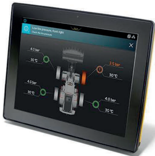
รูปที่ 6 แสดงการแจ้งเตือนความดันลมยางล้อหน้าขวาอ่อนเกินไป ต้องเติมลมยาง ภาพจาก https://www.volvoce.com/united-states/en-us/services/volvo-services/productivity-services/load-assist/tire-pressure-monitoring-system
