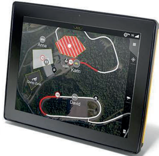
รูปที่ 7 แสดงแผนที่การทำงานของรถตักในแผนที่หน้างานรวม ภาพจาก https://www.volvoce.com/united-states/en-us/services/volvo-services/productivity-services/load-assist/map/
