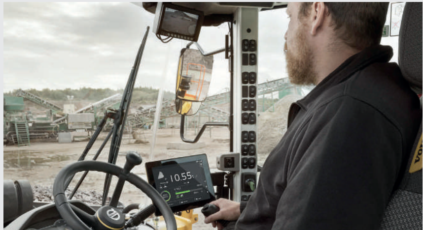
รูปที่ 1 แสดง Load Assist โปรแกรมผู้ช่วยพนักงานขับรถตักล้อยางของบริษัท Volvo ใน Tablet ขนาด 10 นิ้ว
