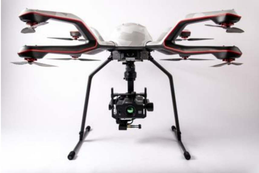
รูปที่ ๑ แสดงโดรนตรวจจับก๊าซรั่วของบริษัท Workswell
