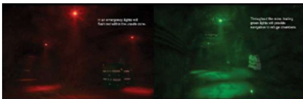
รูปที่ 5 (ซ้าย) แสงไฟสีแดงเพื่อแจ้งอันตรายให้พนักงานเหมืองแร่ออกจากพื้นที่ (กลาง) แสงไฟสีเขียวเพื่อแจ้งทางไปห้องนิรภัย (ขวา) พนักงานเหมืองแร่เดินไปตามทางที่มีแสงไฟสีเขียวเพื่อไปยังห้องนิรภัย ภาพจาก https://minearc.com/guardian-intelligence-network/underground-smart-lighting-node-guardian/
