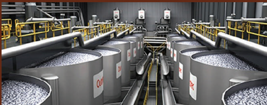
กระบวนการแยกแร่ทองแดงด้วยกระบวนการลอยแร่
